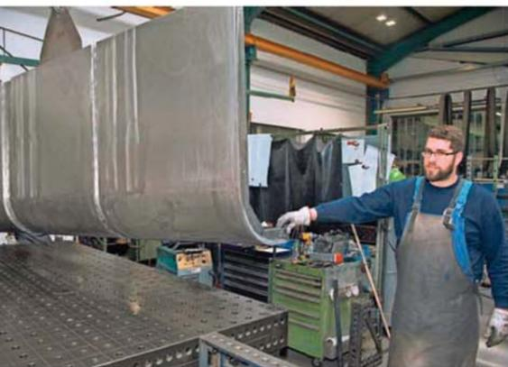
Bei Mörz liebt man das schrittweise Rundbiegen mit der Oberwange gegen Unter- und Biegewange der SPB Evolution UD.
