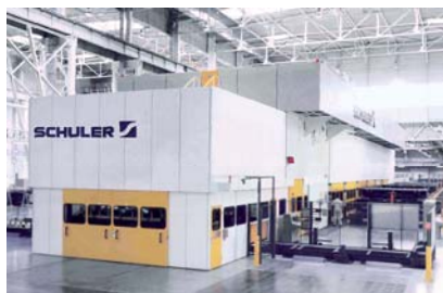
Lärmschutzeinhausung einer Schuler-Crossbar-Transferpresse, Reinraumhalle des Skoda-Presswerkes in Tschechien.
